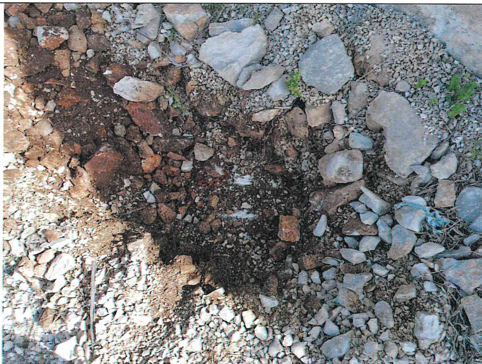
Esecuzione pozzetto geognostico e prelievo dei campioni Ca5 alle diverse profondità
