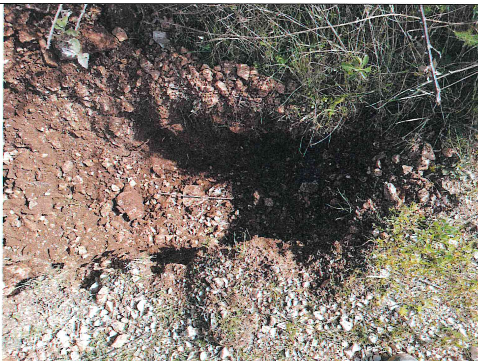
Esecuzione pozzetto geognostico e prelievo dei campioni Ca6 alle diverse profondità
