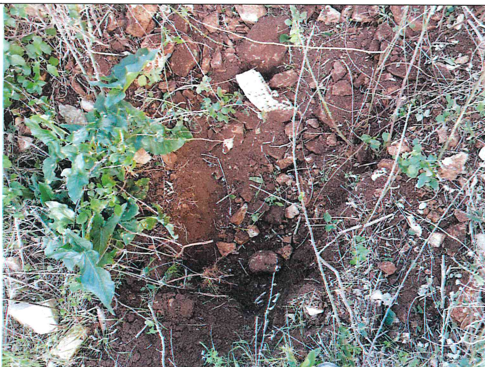
Esecuzione pozzetto geognostico e prelievo dei campioni Ca7 alle diverse profondità
