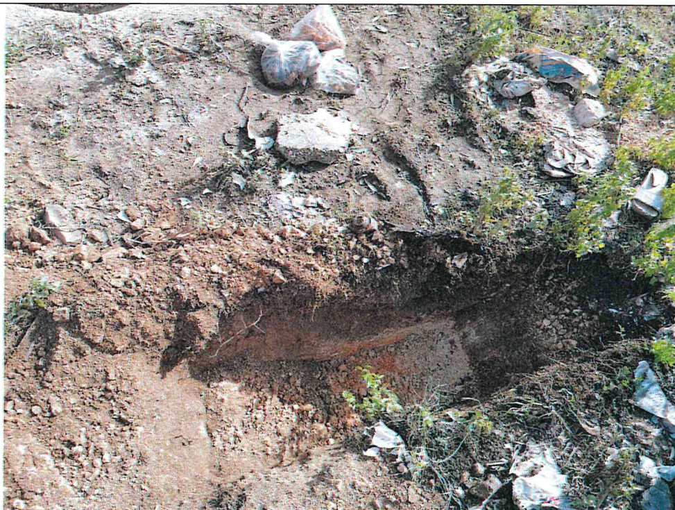
Esecuzione pozzetto geognostico e prelievo dei campioni Ca4 alle diverse profondità
