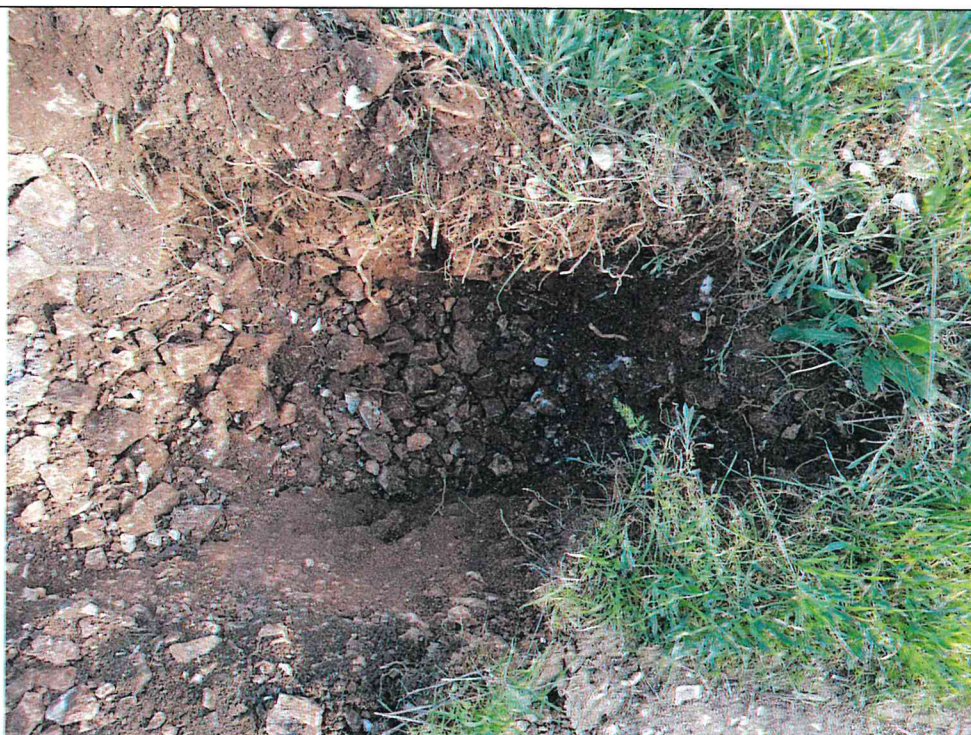
Esecuzione pozzetto geognostico e prelievo dei campioni Ca9 alle diverse profondità
