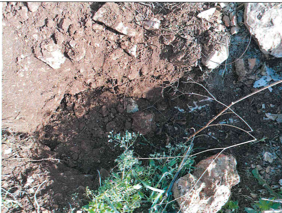
Esecuzione pozzetto geognostico e prelievo dei campioni Ca8 alle diverse profondità
